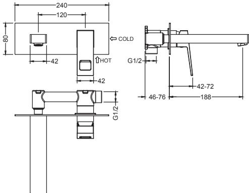
Определите точное место установки смесителя. Подведите водопроводные трубы так, чтобы монтаж и демонтаж смесителя не вызывал затруднений. Убедитесь, что подача горячей воды слева, а холодной справа. Закрепите корпус смесителя к стене при помощи крепежных винтов. Смеситель устанавливается на глубину 46-76 мм от внешней поверхности стены. Промойте впускные трубы перед окончательной установкой. Убедитесь в герметичности всех соединений.
